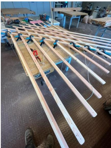
Am Freitagmorgen knüpften Manuel und ich in 4 ½ Stunden das erste Scherengitter. Das Knüpfen ging zunehmend schneller, das Fädeln, Festklammern und Abschneiden lässt sich kaum beschleunigen. Wir waren ziemlich stolz auf das erste funktionierende Scherengitter.
