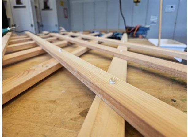
Derweil arbeitet Dieter schon an der Herstellung der Dachstangen. Für die Zapfen an den Enden hat er schon eine Spezialeinrichtung gebaut. Wir hobeln, schleifen und bohren die Dachstangen dann.
